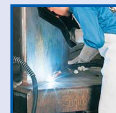
Hochleistungs-Schweißen mit PU 520 DW, Meyer-Werft, Papenburg
