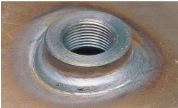
Spritzerfreies Schweißen im Pulse-Arc Betrieb.
